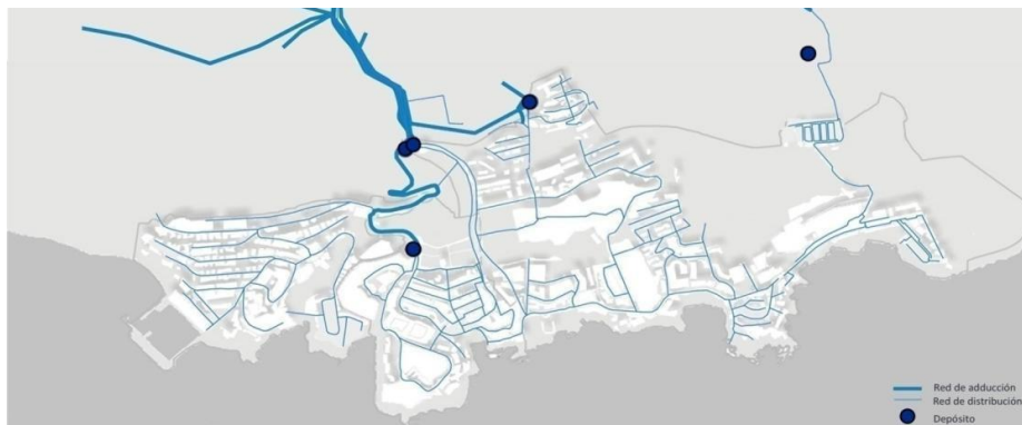
Fuente: PMM Puerto de Santiago – Santiago del Teide – Guía de Isora. Esquema red de abastecimiento de aguas en Puerto de Santiago.
